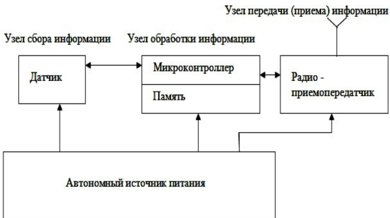
Рис. 5. Обобщенная схема узла беспроводной сенсорной сети
